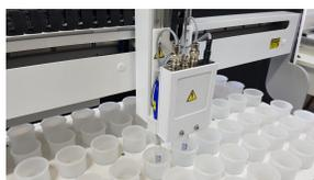
A bandeja pode ser retirada facilmente sem a necessidade de ferramentas, apenas elevando-a. | O encaixe fácil e preciso permite que se tenha configurações para diferentes tipos de RACKS ou tubos. | Possui mesa fabricada em alumínio estrutural de alta resistência mecânica e ao ataque químico, garantindo o trabalho ergonômico.
